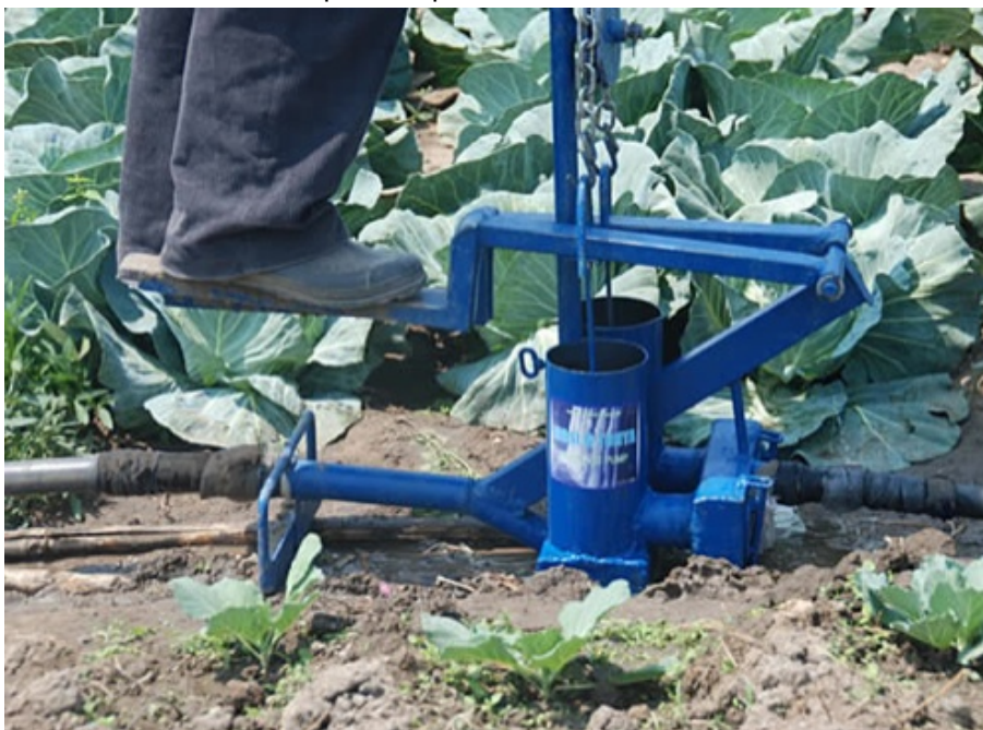
"Mosi-o-Tunya" (la pompe qui tonne) ou pompe à pression
