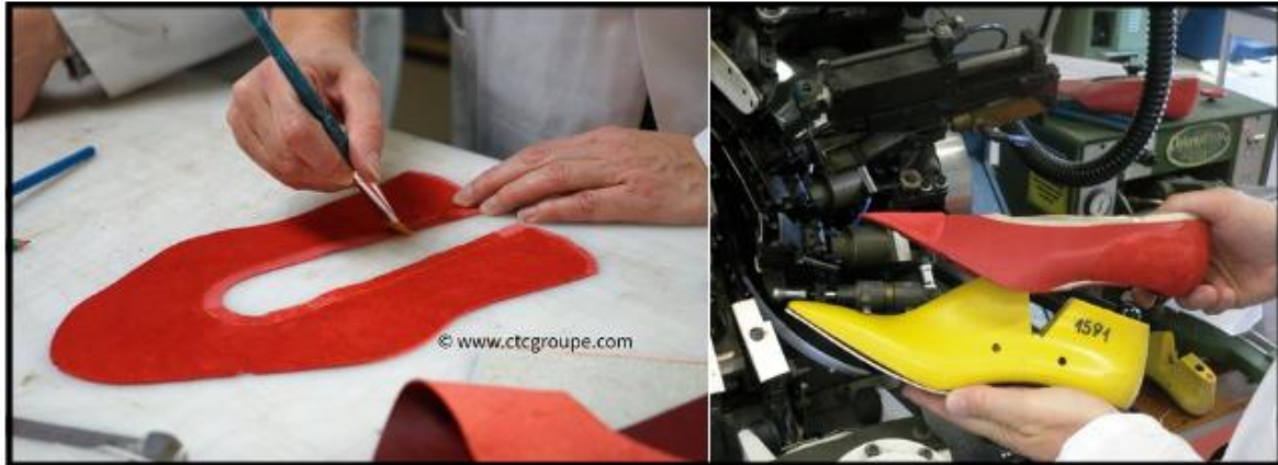
Tige à plat (photo de gauche) et tige avant mise en forme (photo de droite), positionnée sur une forme (support jaune) ; source : CTC.
