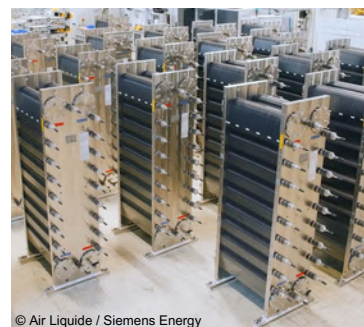
© Air Liquide / Siemens Energy Electrolyseurs
