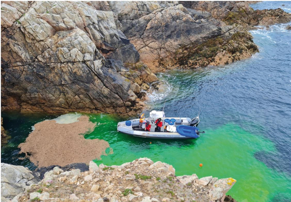
→ Test à la fluorescéine (inoffensif pour l'environnement) pour évaluer le comportement des masses d'eau à la sortie d'un gouffre en contrebas d'une décharge littorale.
