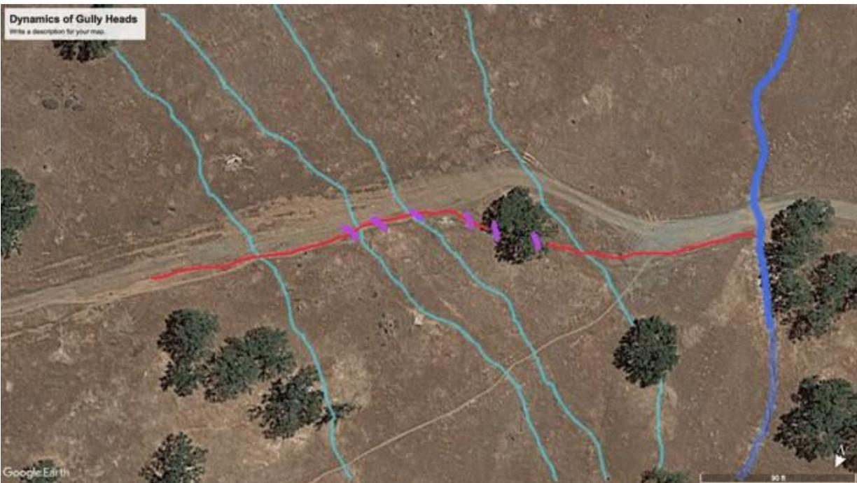
Plusieurs petits suintements et canaux drainaient autrefois la pente sur le côté gauche de ce drainage. Les lignes bleu clair mettent en évidence certains de ces drainages. Cependant, lorsque la route du ranch a été nivelée à travers les pentes, elle a capturé le ruissellement de ces drainages latéraux et les a progressivement rassemblés dans un drainage défini par l'ornière de la route que j'ai marqué en rouge.
