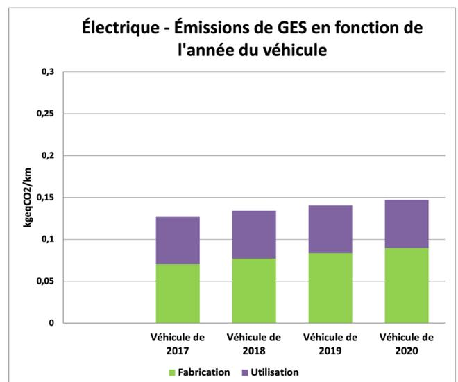
Voiture Électrique : Émissions de gaz à effet de serre des citadines de 2020 en fonction de l'âge du véhicule avec amortissement de la fabrication - Paul Scherrer Institut
