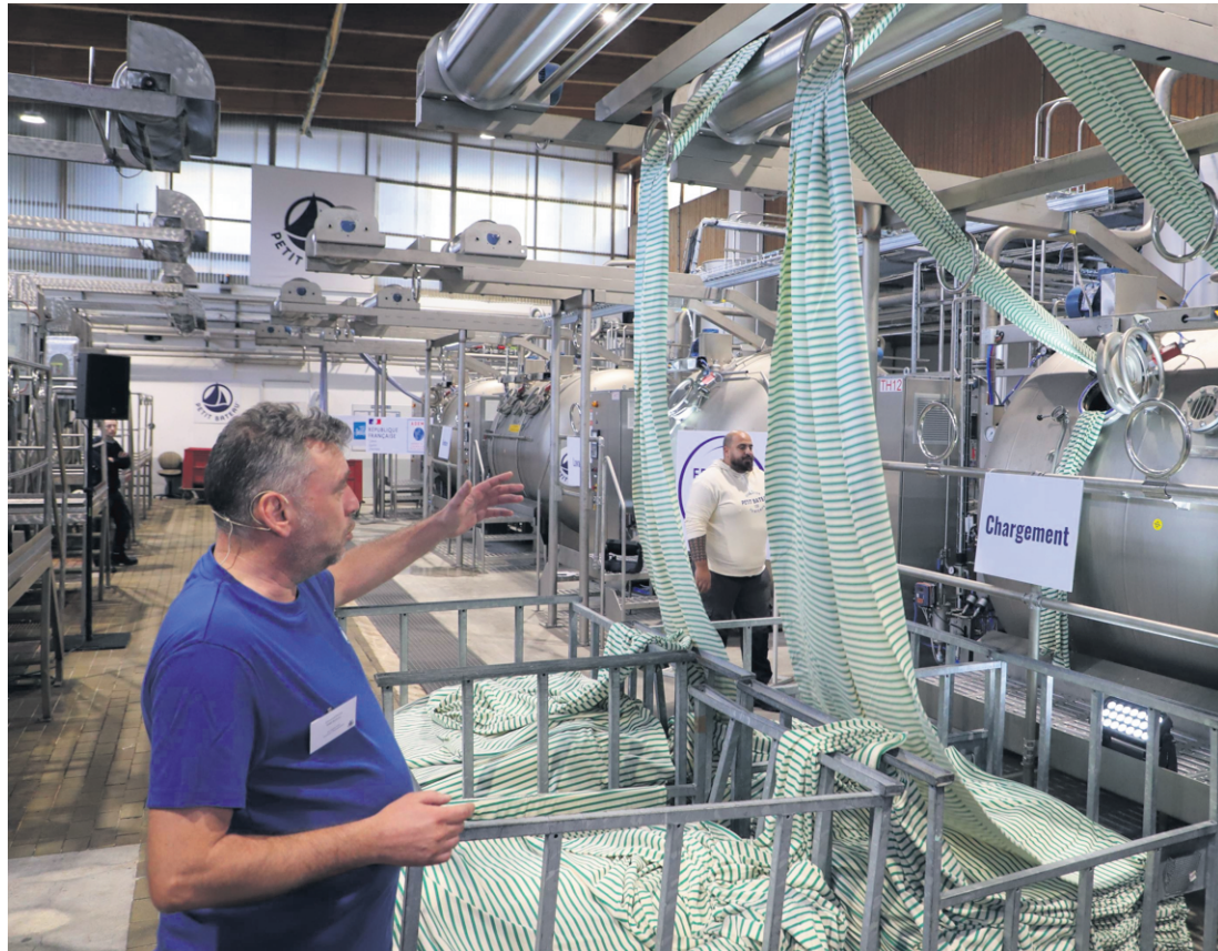
Les nouvelles machines de l'atelier de teinture consomment 30 % d'eau en moins par kilo de tricot que les modèles traditionnels. (Photo B. D.)
