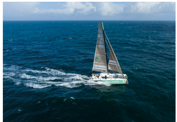
Bateau We Explore construit à 50 % en fibres de lin 2 nd de la route du Rhum 2022 classe multi rhum
